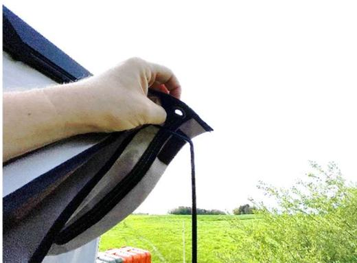
7. Biegen Sie die Federstahlgestänge nach oben und fixieren diese in den dafür vorgesehenen Ösen.
