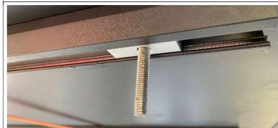
4. Führen Sie die Gleitplatten mit den M8 Schrauben in die Montageschienen ein.
