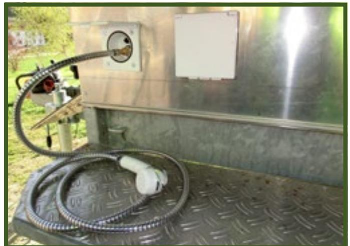
▲ Steckdosen: Stromeinspeisung und Außendusche wurden mit Standard-Anschlüssen aus der Campingtechnik realisiert.
