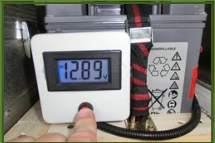
▲ **Eigenbau-Lösung:** Die Ladeanzeige wurde aus Elektronik-Bauteilen selbst gefertigt und funktioniert prima.
