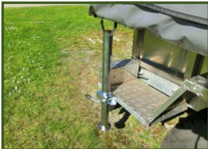
▲ Abnehmbar: Für sicheren Stand sind die Stützen unerlässlich, im Gelände lassen sie sich schnell abmontieren.
