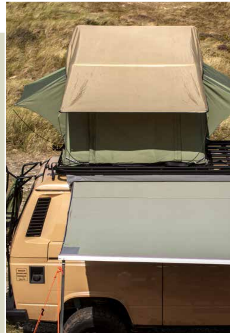
Vor der Montage sollte festgelegt werden, in welche Richtung das Zelt geöffnet werden soll. Anbauteile wie Markisen oder auch Fahrradträger lassen meist nur wenige Alternativen offen.
