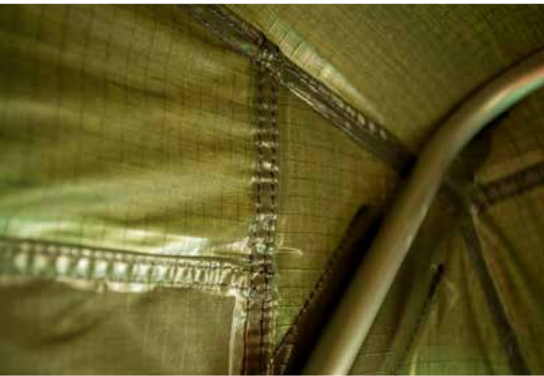
Verschweißte Doppelnähte sollten auch starkem Unwetter standhalten können.
