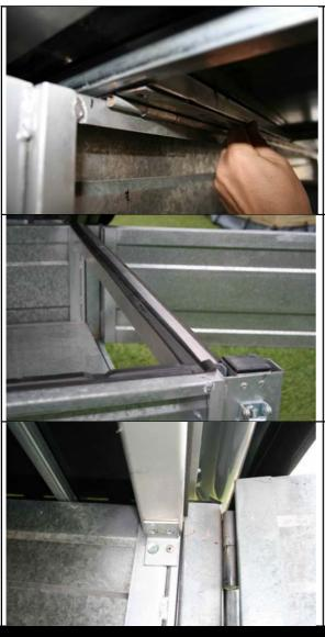
Das Stangenscharnier muss am original Stahlrahmen des Zeltes befestigt werden. Bitte lesen Sie das Kapitel: "Permanente Montage mit Gasdruckfedern"
