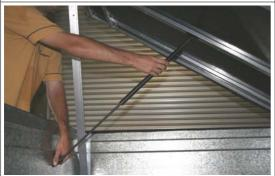
Die Gasdruckfedern werden an der Anhänger-Innenwand und dem Stahlrahmen des Zeltes befestigt.
