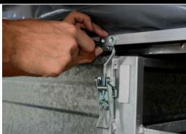
Die Schnappverschlüsse sollten an beiden Ecken (gegenüberliegende Seite des Scharniers) angebracht werden um das Zelt zu schließen und während der Fahrt zu sichern.
