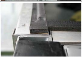
Verwenden Sie die Schaumstoffdichtung um das Zelt mit dem Anhänger rundum wasser- und staubdicht zu versiegeln.
