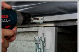
Befestigen Sie die Schnappverschlüsse mit Bohrschrauben am Anhänger und den Stahlstreben des Zeltrahmens.
