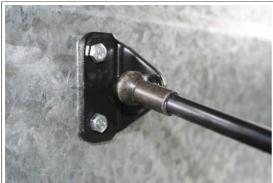
Verwenden Sie M6 Schwerlastschrauben, Beilagscheiben und Splitringe um die Halterung mit der Anhängerwand zu verschrauben.
