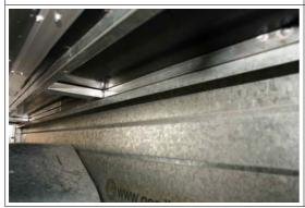
Vergewissern Sie sich, dass der Zeltrahmen mit den Anhängerwänden ausgerichtet ist.
