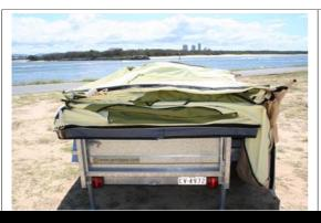
Ziehen Sie die Bodenplane an beiden Ecken gleichzeitig über den Anhänger bis er in voller Größe aufliegt.
