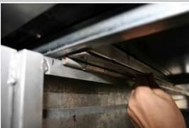
Richten Sie nun den Stahlrahmen an den Anhängerwänden und dem Stangenscharnier aus. Der Rahmen sollte wenn möglich direkt auf den 3 Seitenwänden Ihres Anhängers aufliegen. Dies ist nötig um Ihn später abzudichten.
