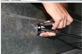
Markieren Sie nun die Position der Gasdruckfederhalterungen an den Anhängerwänden.
