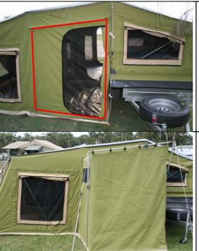
Verbinden Sie den Duschraum mit 4 Reißverschlüssen am Hauptzelt und schließen sie die Kletterschlusslaschen.
