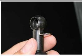
Der Sicherheitsstift wird mit einer leichten Drehbewegung entriegelt und kann dann nach unten ausgezogen werden.
