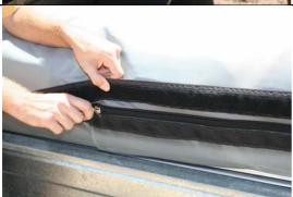
Bitte vergewissern Sie sich, dass die Reiseabdeckung ohne Spannung das Zelt abdeckt. Dies verhindert unnötigen Zug auf den Reißverschluss beim Verschließen. Der Klettverschluss verhindert das Eindringen von Staub und Regen während der Fahrt.
